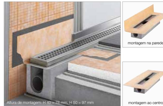
Schlüter-KERDI-LINE-H um conjunto completo para chuveiros à face do solo com escoamento horizontal. Pode ser utilizado universalmente para a montagem em posição central numa superfície ou na área da parede. Na flange de ligação circundante do corpo do canal existe de fábrica uma guarnição colada fixamente de Schlüter-KERDI. Serve para uma ligação segura do corpo do canal à impermeabilização conjunta, tanto na área do solo como em paredes verticais.
